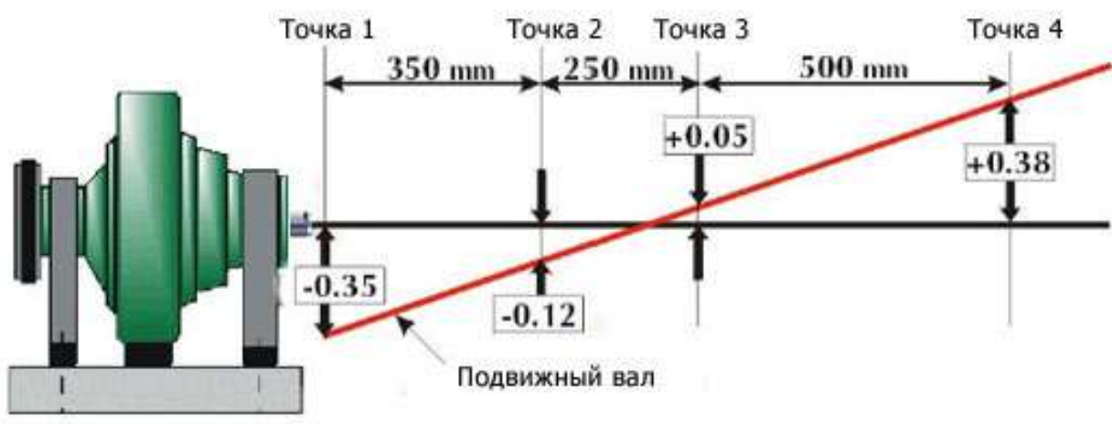
Рис. 8. Смещение вала. Отклонение оси вращения одного вала относительно оси вращения другого в заданной точке (или плоскости) по длине вала
