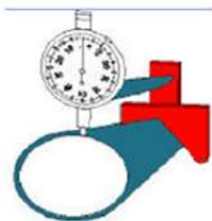
Рис. 26. Определение прогиба, ноль в положении 12:00
