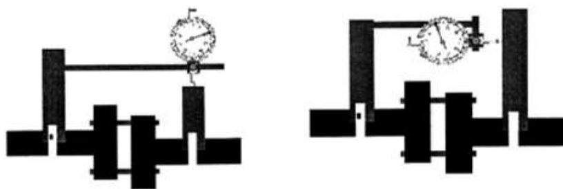
Рис. 35. Собранный соединительная муфт на валах с вспомогательными консолями и радиальным и осевым индикатором
