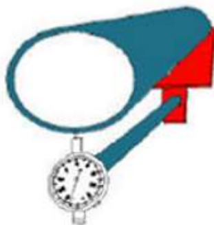
Рис. 27. Определение прогиба, измерение в положении 6:00
